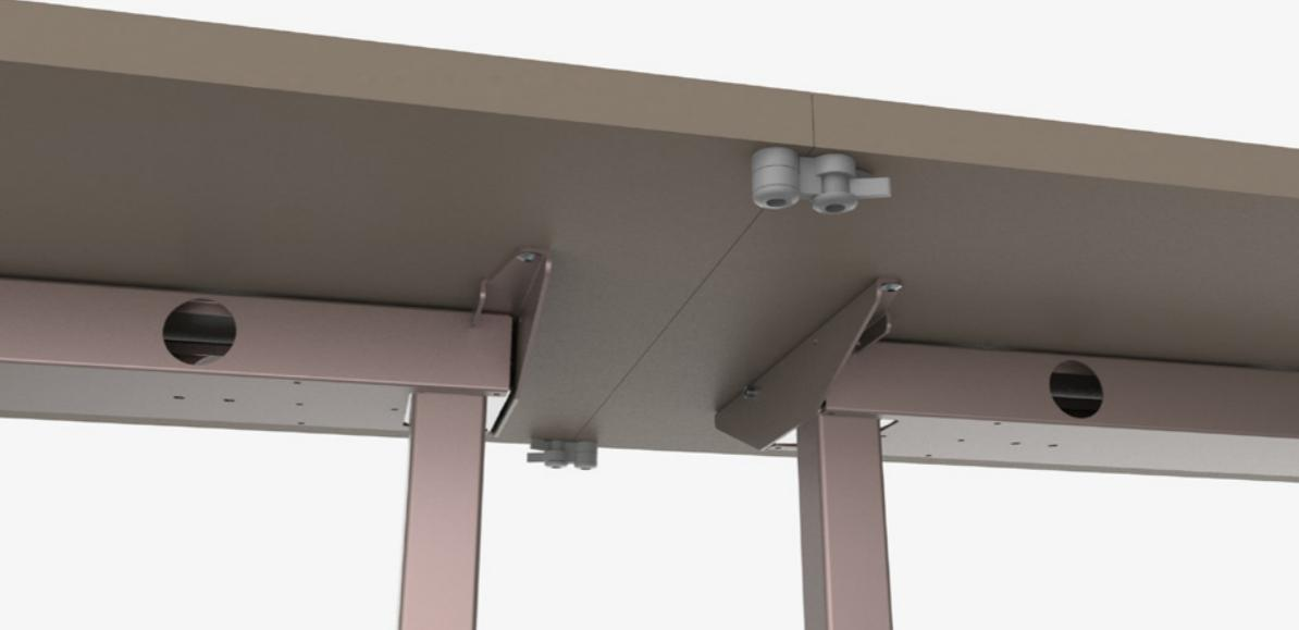
La struttura della scrivania è composta da due colonne verticali in alluminio estruso a sezione quadrata 50x50 mm, spessore 2 mm, con piedi in lamiera d'acciaio presso-piegata dello spessore 3 mm e trave strutturale in lamiera d'acciaio spessore 1,2 mm. La trave, che serve anche da canale portacavi, viene fissata alle colonne tramite dei giunti realizzati in pressofusione di zama mentre il piano è fissato alla struttura tramite staffe in lamiera d'acciaio presso-piegata dello spessore di 3 mm.
